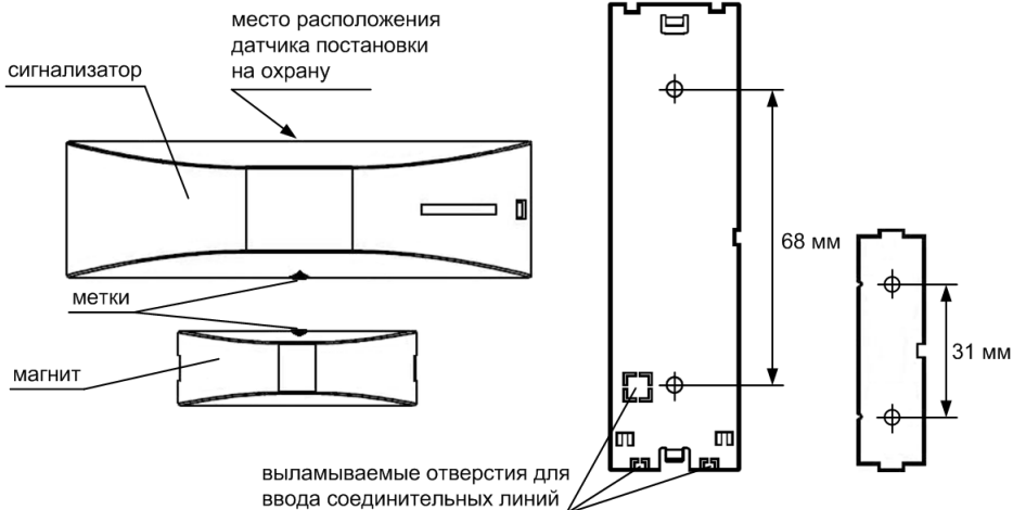
Рис.9 Схема установки, присоединительные размеры
