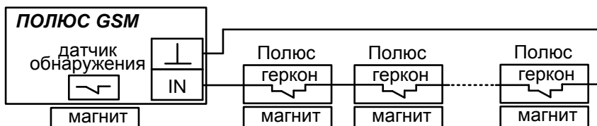
Рис.6а Схема подключения внешних датчиков. Значение «2» параметра №37
